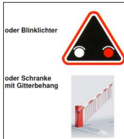
Abb. 4: Signalisation/Sicherung bei Übergang im Betrieb.
